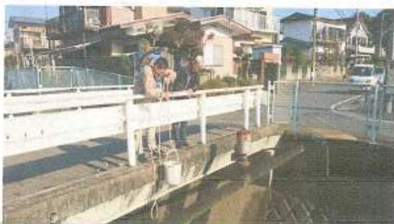
橋の上からバケツを投げ試料の水を採る
